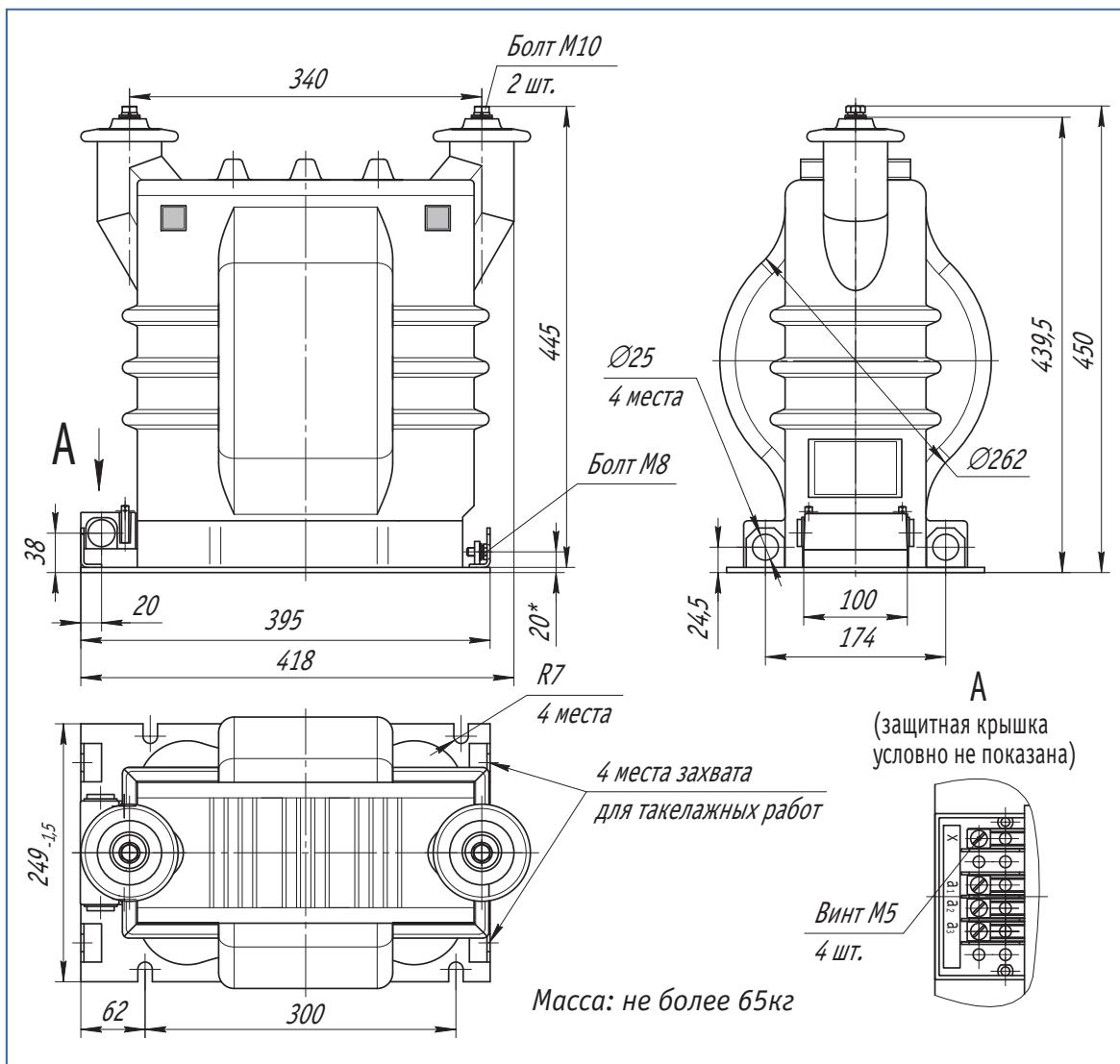
Габаритные, установочные и присоединительные размеры трансформаторов
