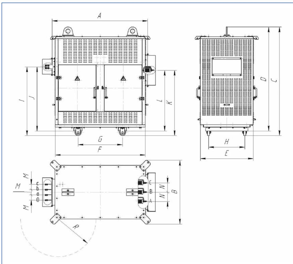
Габаритные, установочные и присоединительные размеры трансформаторов типа ТС3
