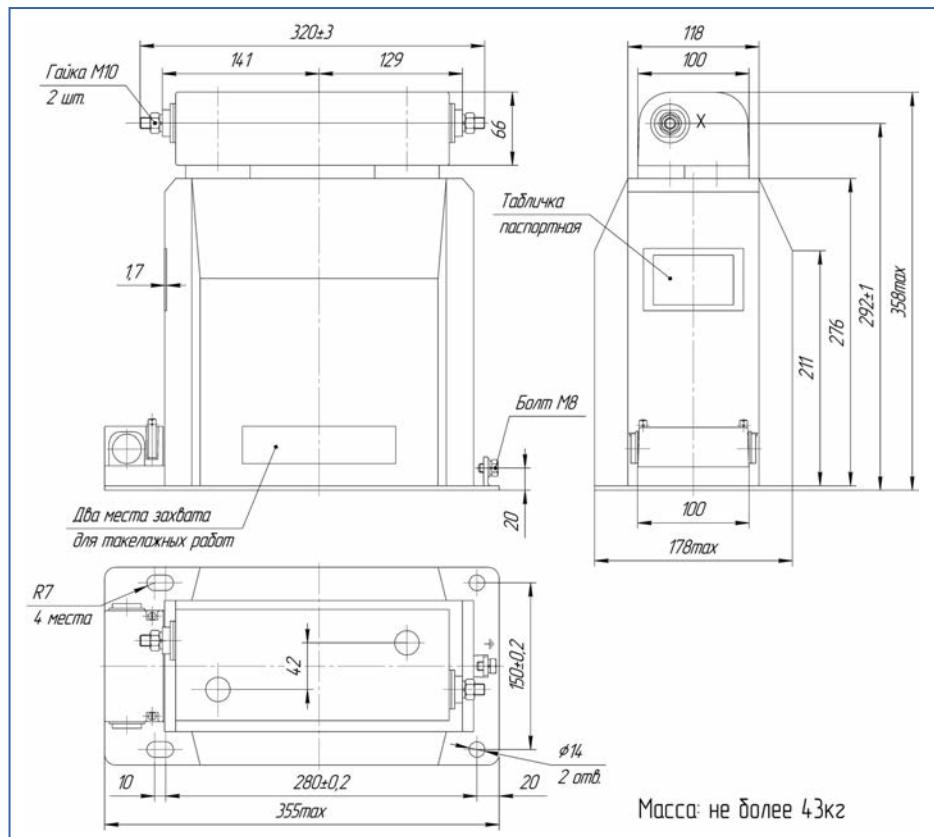
Габаритные, установочные и присоединительные размеры трансформаторов
