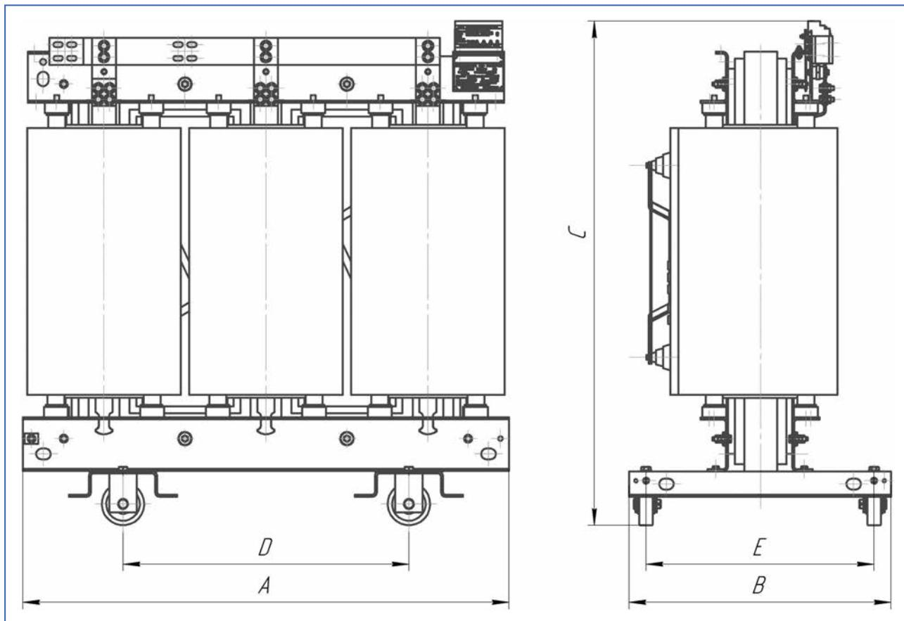
**Габаритные, установочные и присоединительные размеры трансформаторов типа
