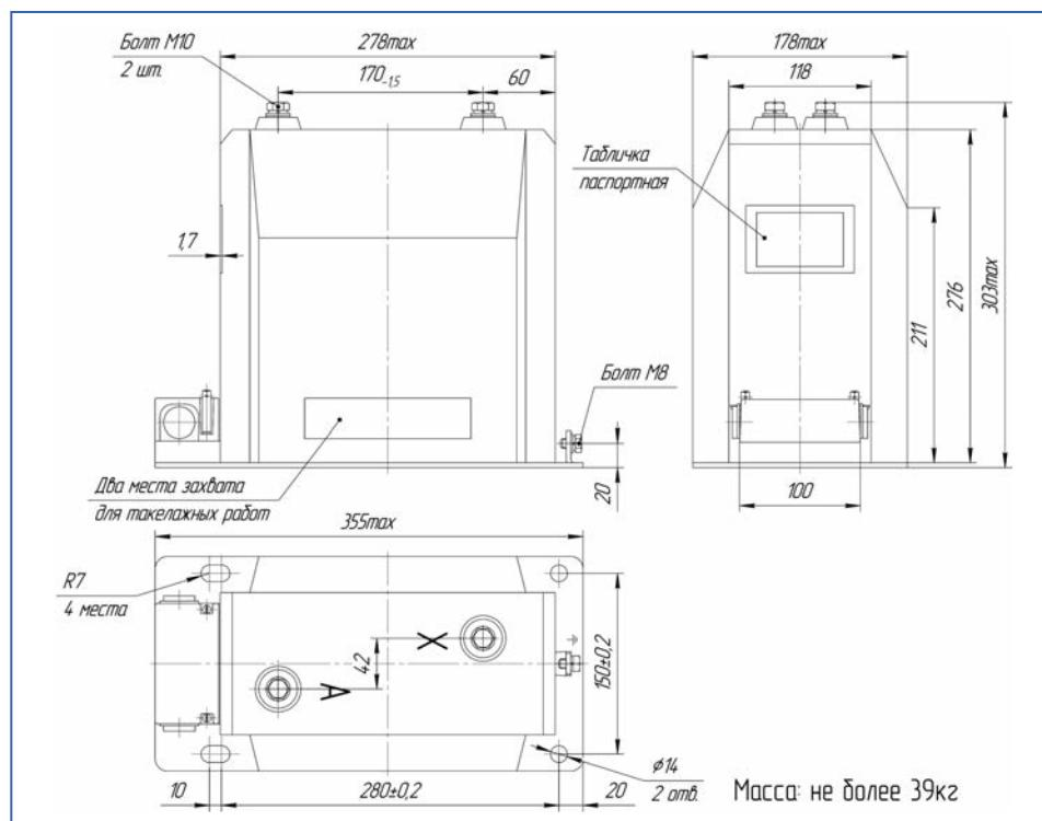
Габаритные, установочные и присоединительные размеры трансформаторов
