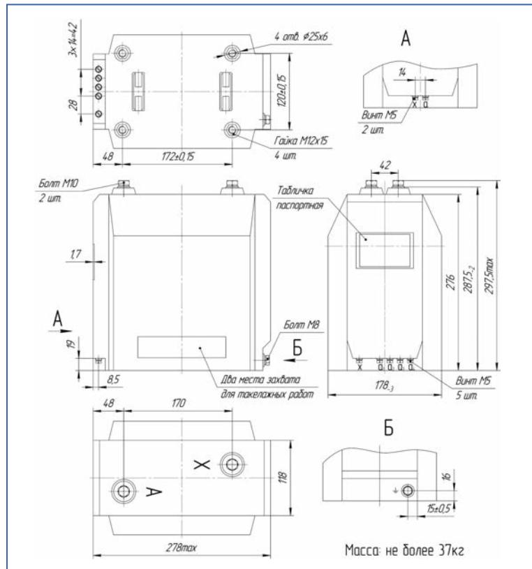
Габаритные, установочные и присоединительные размеры трансформаторов ОЛС-СЭЩ°-1,25/6(10) У(T)2.
