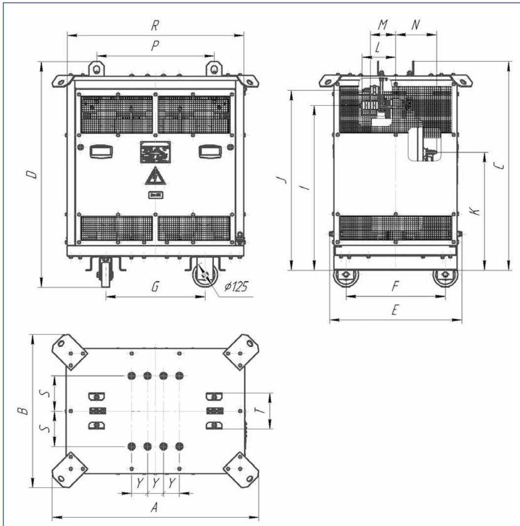
**Габаритные, установочные и присоединительные размеры распределительных трансформаторов ТЛС-СЭЩ®**
