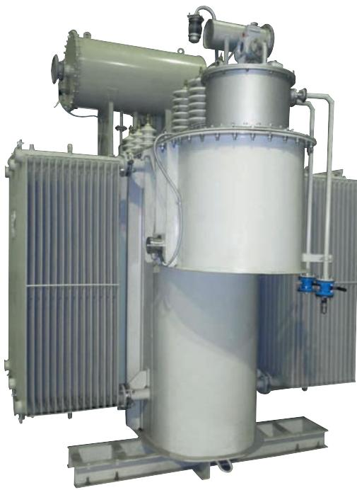
Трансформаторы силовые масляные типа ТМ-СЭЩ® с переключением ответвлений обмоток без возбуждения (ПБВ) и ТМН-СЭЩ® с регулированием напряжения под нагрузкой (РПН) общего назначения мощностью от 1000 до 6300 кВА напряжением до 35 кВ включительно трехфазные двухобмоточные предназначенные для передачи и распределения электроэнергии переменного тока в электросетях напряжением до 35 кВ включительно, применяемые для нужд экономики страны.
