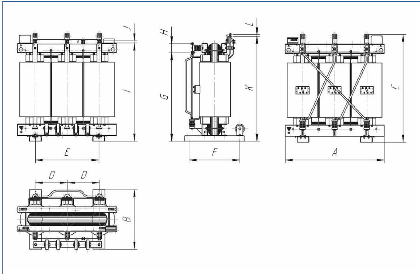
**Габаритные, установочные и присоединительные размеры трансформаторов типа ТС
