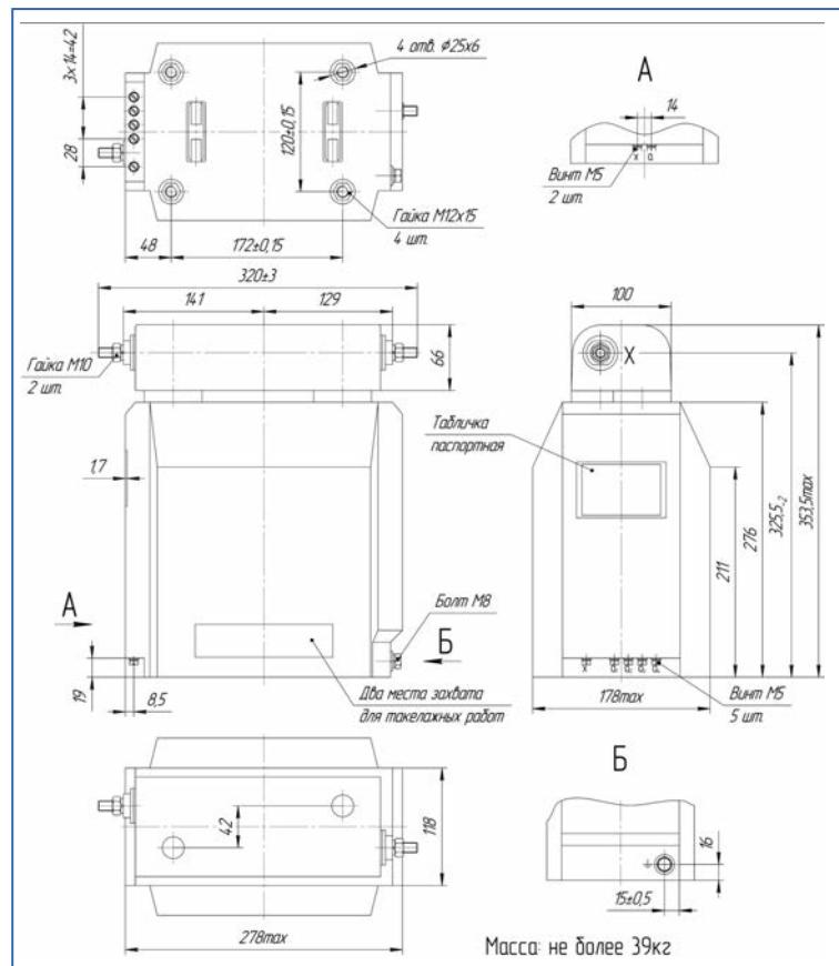
Габаритные, установочные и присоединительные размеры трансформаторов ОЛС-СЭЩ°-1,25/6(10)-1 У(T)2.
