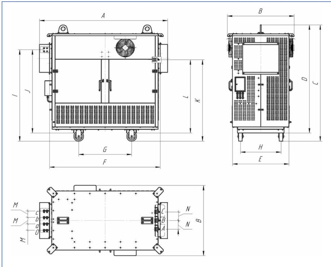
Габаритные, установочные и присоединительные размеры трансформатора
