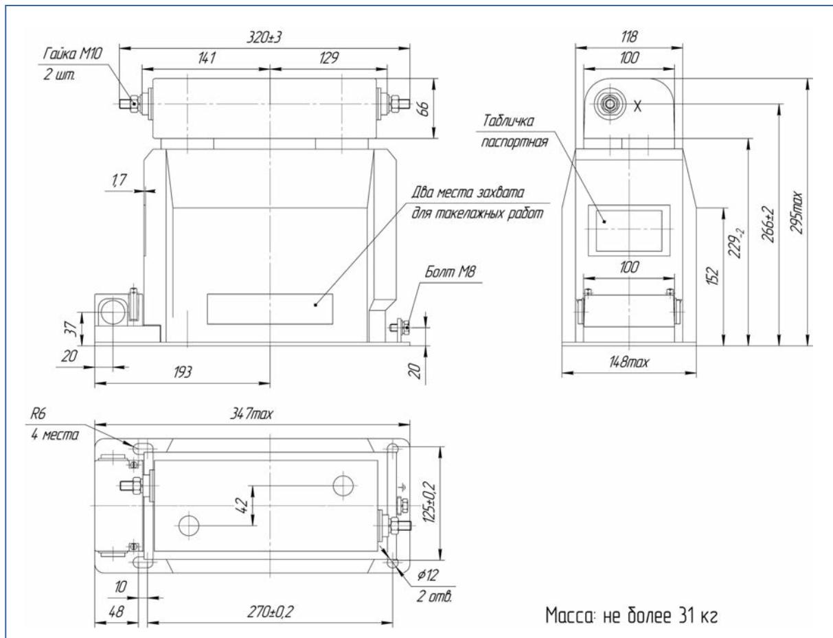
Габаритные, установочные и присоединительные размеры трансформаторов
