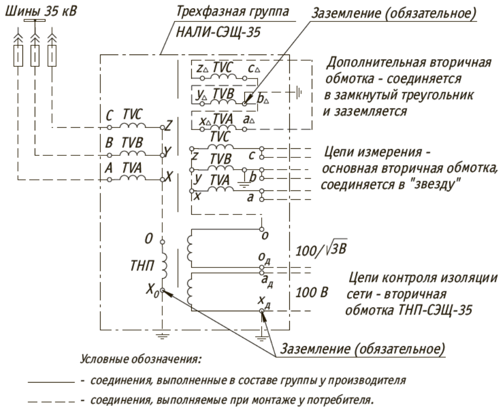
Рис. 136. Принципиальная электрическая схема соединения обмоток трансформаторов напряжения трехфазной антирезонансной группы НАЛИ-СЭЩ ® -35 (с одной основной вторичной обмоткой)
