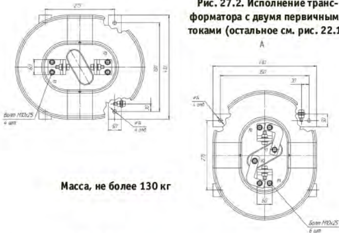
Рис. 27.1., 27.2. Габаритные, установочные, присоединительные размеры и масса трансформатора тока ТОЛ-СЭЩ*-35-IV-14,15,16
